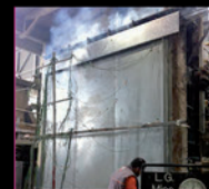
► Ensayo puerta corredera en APPLUS
